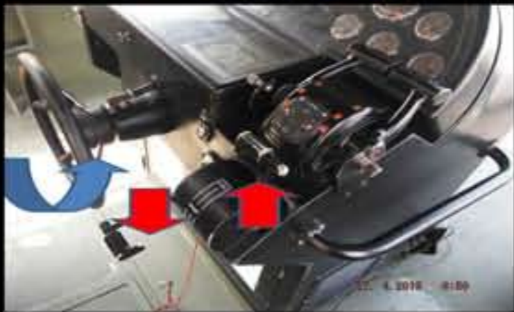
เมื่อต้องการกลับลำด้านซ้าย ให้ตั้งคันบังคับฝา เปิด-ปิดประตูเครื่องพ่นน้ำข้างซ้ายมาตำแหน่ง ถอยหลังสุด ข้างขวายังเดินทางหน้าสุดอยู่
