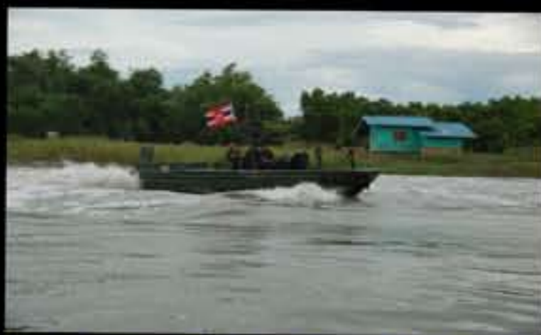
การใช้คันบังคับฝาเปิดปิดเครื่องพ่นน้ำเพียงอย่างเดียว โดยมิต้องใช้พวง จะไม่ทำให้เกิดอาการเอียงของเรือ และจะทำให้การบังคับเรือเป็นไปตามความต้องการได้ง่าย
