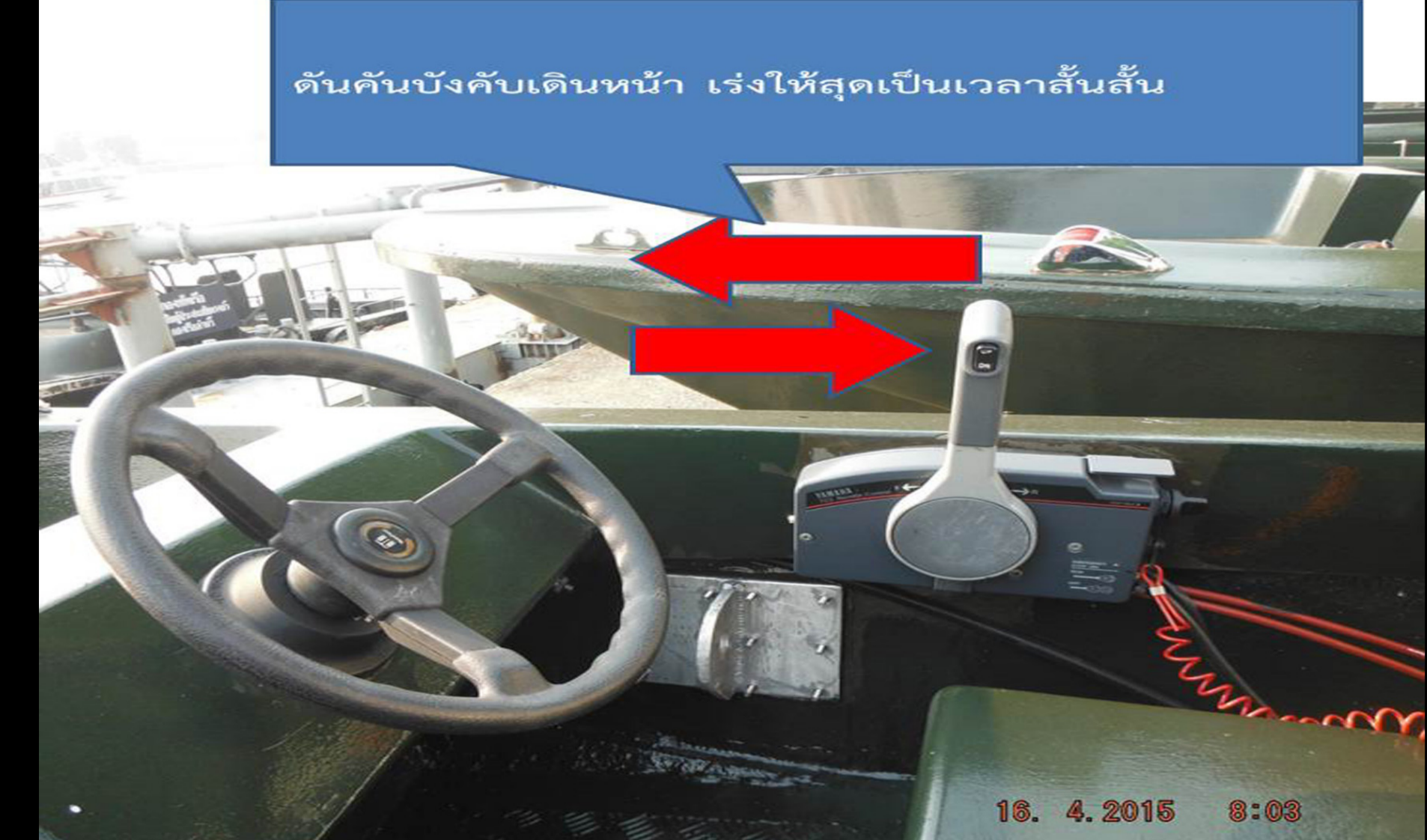
เมื่อเรือกลับลำไปทางขวาประมาณครึ่งรอบ ให้หยุดเครื่อง ดึงคันบังคับมาตำแหน่งเกียร์ว่าง
