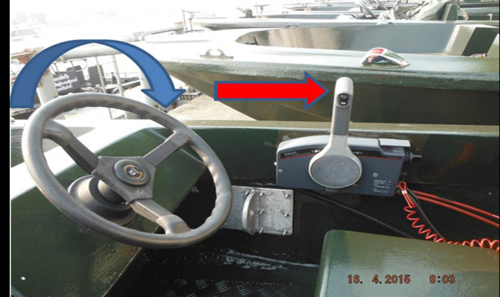
แล้วดันคันบังคับเดินทาง เร่งให้สุด เป็นเวลาสั้นสั้น เพื่อให้หัวเรือหันอย่างรวดเร็ว
