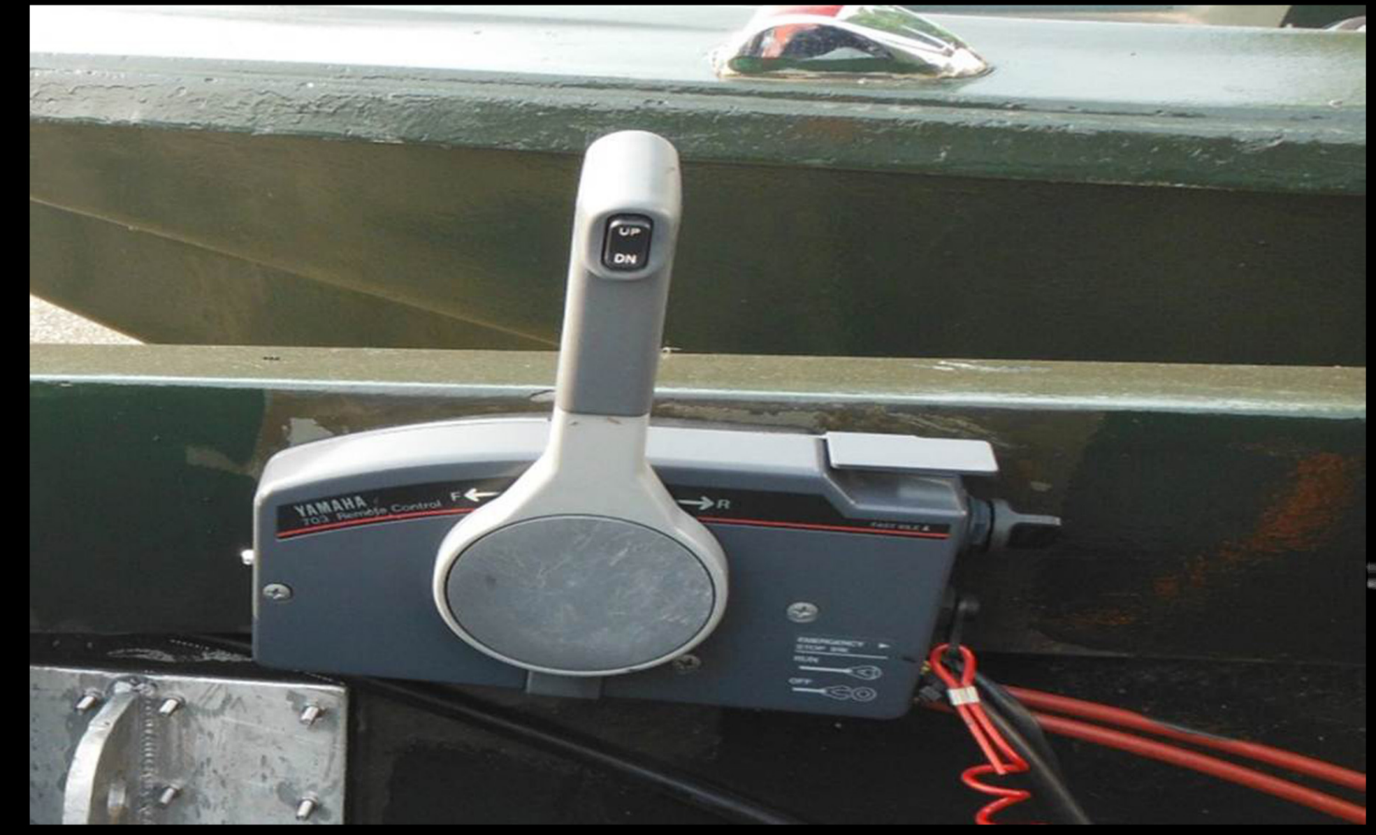
เมื่อดึงคันบังคับมาตำแหน่งเกียร์ว่าง จะต้องระวังไม่ให้ เลยไป ตำแหน่งเกียร์หลัง เมื่อเข้าเกียร์ว่างแล้วจะต้อง หมุนพังกาให้เร็ว และเข้าเกียร์เดินทางหน้าเร่งให้สุดและเร็ว เพื่อให้เรือมีอาการโดยเร็ว จะทำให้ใช้ระยะทางหน้าสั้นลง
