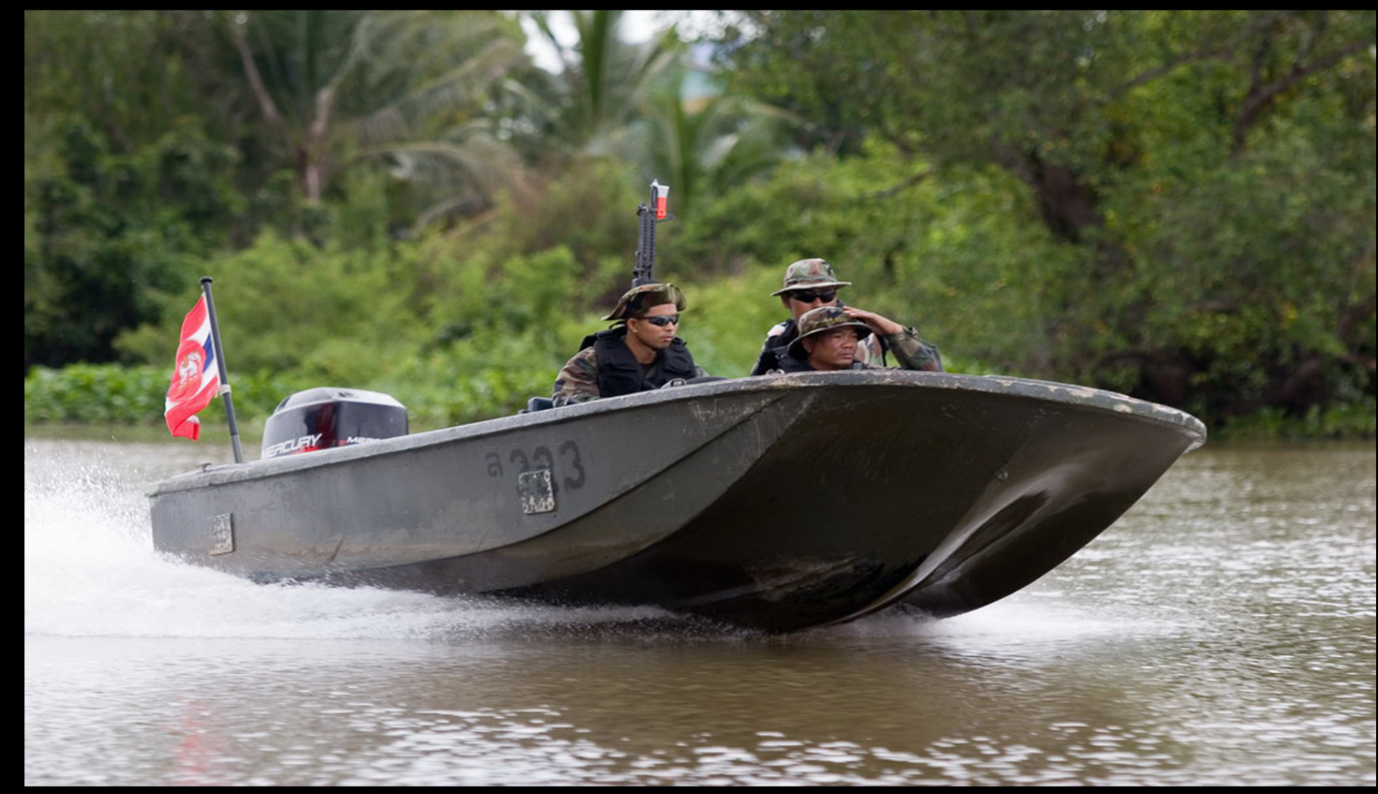
เรือแล่นมาด้วยความเร็วสูง เมื่อต้องการเลี้ยวกลับลำ ทางขวาดึงคันบังคับมาตำแหน่งเกียร์ว่าง พร้อมกับหมุนเลี้ยวพังกาไปทางขวา จนหมดมุมหัน
