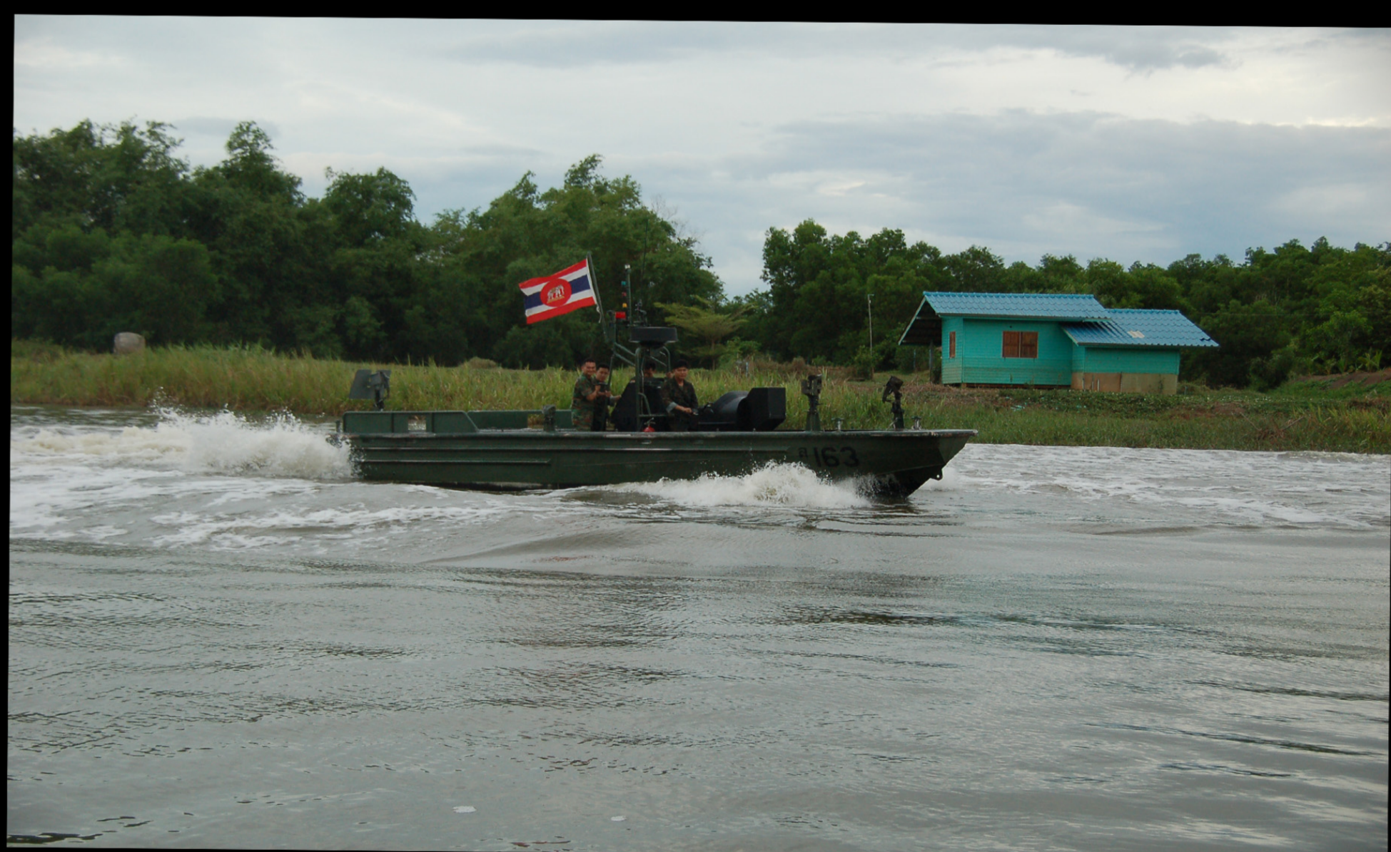
การใช้คันบังคับฝาเปิดปิดเครื่องพ่นน้ำเพียงอย่างเดียว โดยมิต้องใช้พังกา จะไม่ทำให้เกิดอาการเอียงของเรือ และจะทำให้การบังคับเรือเป็นไปตามความต้องการได้ง่าย
